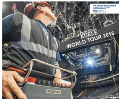
Die Fernsteuerung garantiert eine einfache und intuitive Bedienung auf 10 Kanälen. Die Spannungsversorgung erfolgt über einen 7,2 V/500 mAh-Wechselakku mit Temperaturbereich.
