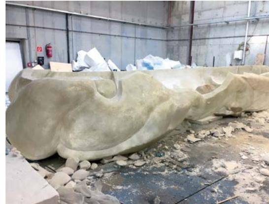
Eine 40 cm lange Gipsvorlage diente als Modell für den 8,5 m x 3 m großen Kokon. Präzises Arbeiten war dank 3D-Scan-Technologie möglich.
