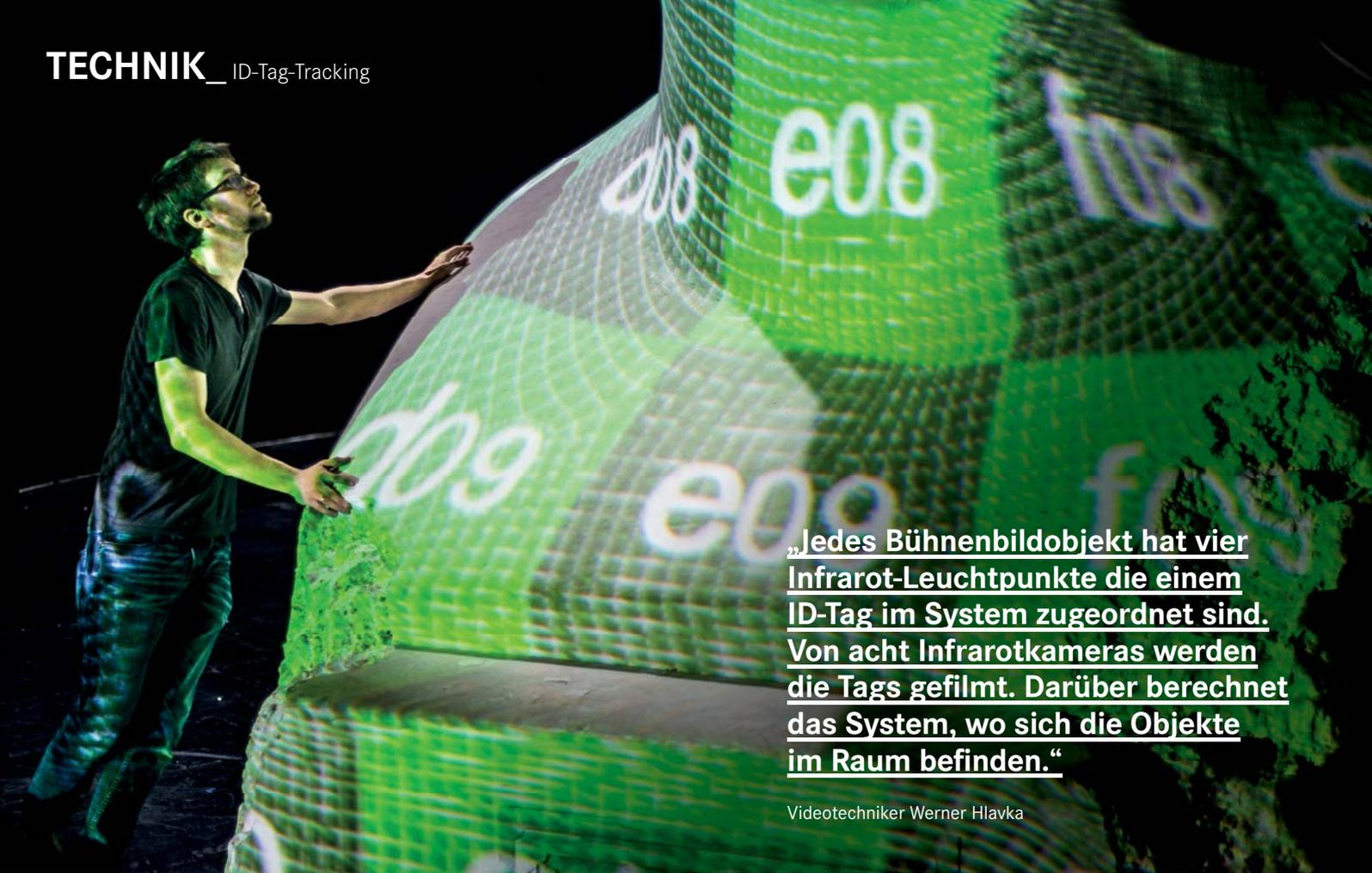
**„Jedes Bühnenbildobjekt hat vier Infrarot-Leuchtpunkte die einem ID-Tag im System zugeordnet sind. Von acht Infrarotkameras werden die Tags gefilmt. Darüber berechnet das System, wo sich die Objekte im Raum befinden.“**
