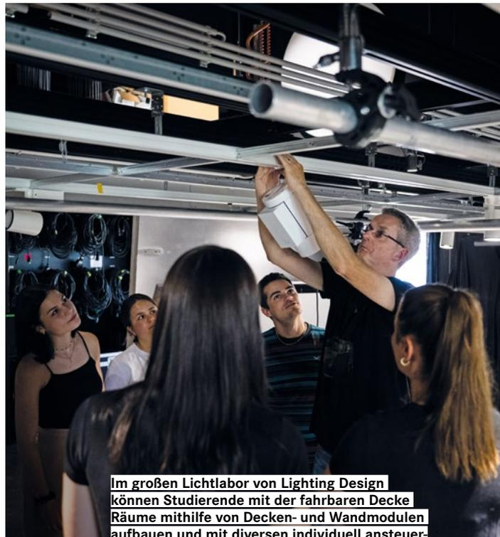
Im großen Lichtlabor von Lighting Design können Studierende mit der fahrbaren Decke Räume mithilfe von Decken- und Wandmodulen aufbauen und mit diversen individuell ansteuerbaren Leuchten Beleuchtungssituationen simulieren. Außerdem stehen neueste Leuchten und Steuerpulte aus der Veranstaltungstechnik zur Verfügung.
