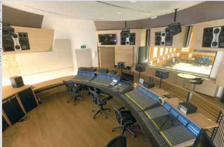
Das Mischpult „SSL Duality Delta 96 ProStation“ im Regieraum des großen Studios (Studio A) mit 96 analogen Eingangskanälen
