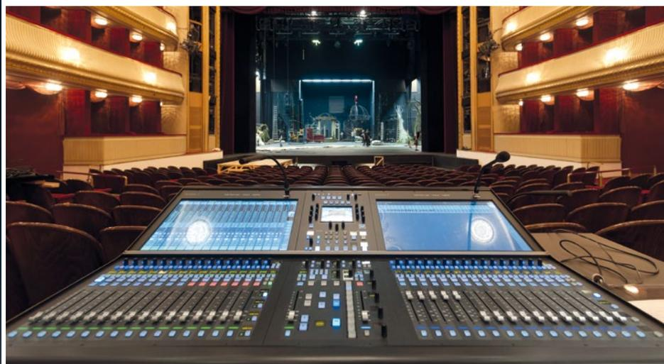
Die mobile Saalregie mit SSL-T wird bei musikalisch aufwändigen Produktionen verwendet.
