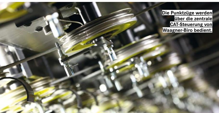
Die Punktzüge werden über die zentrale CAT-Steuerung von Waagner-Biro bedient.
